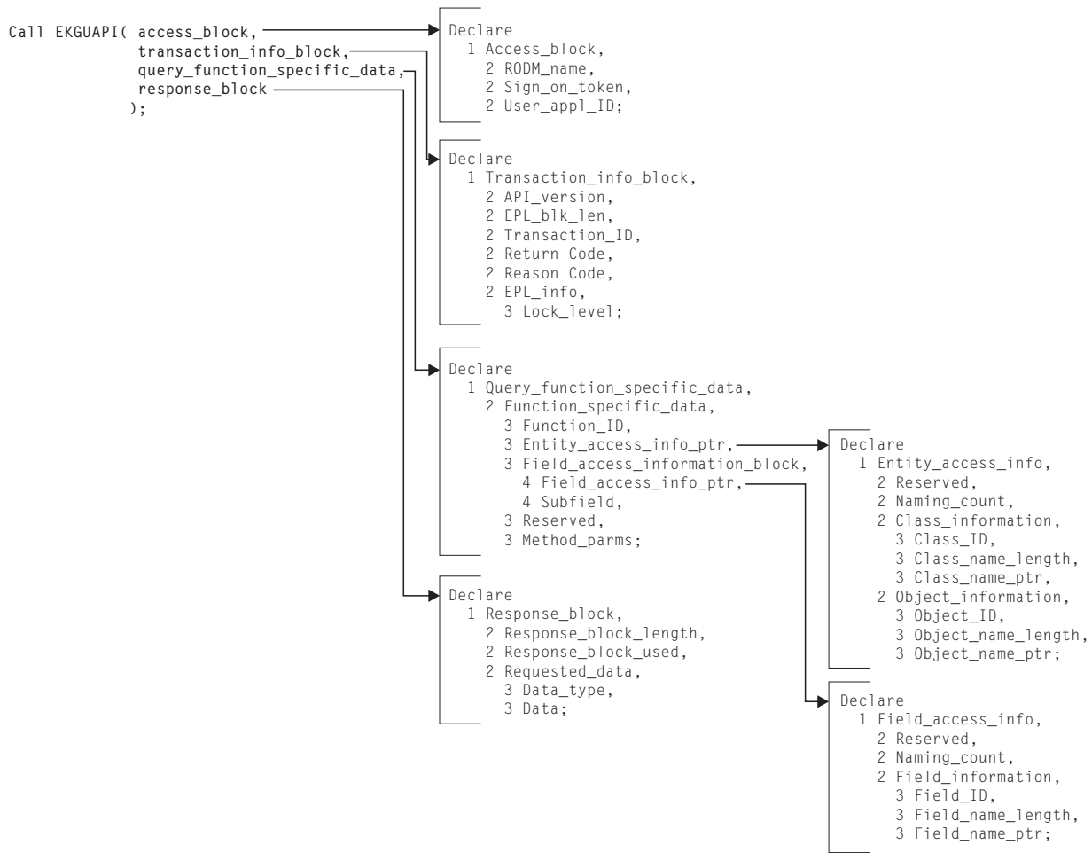
図 73. API 照会機能制御ブロックの例
